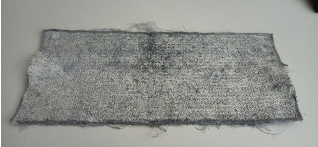
Slika 6 Mreža s TiO_2/CNT-GF imobiliziranim fotokatalizatorom
