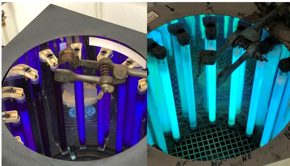
Slika 3. Rayonet fotoreaktor s UV lampama od 300 nm (desno) i 350 nm (lijevo).
