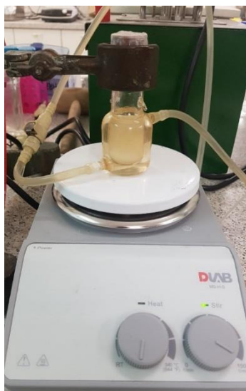
Slika 6. Stakleni šaržni reaktor korišten u integriranom procesu proizvodnje i pročišćavanja biodizela
