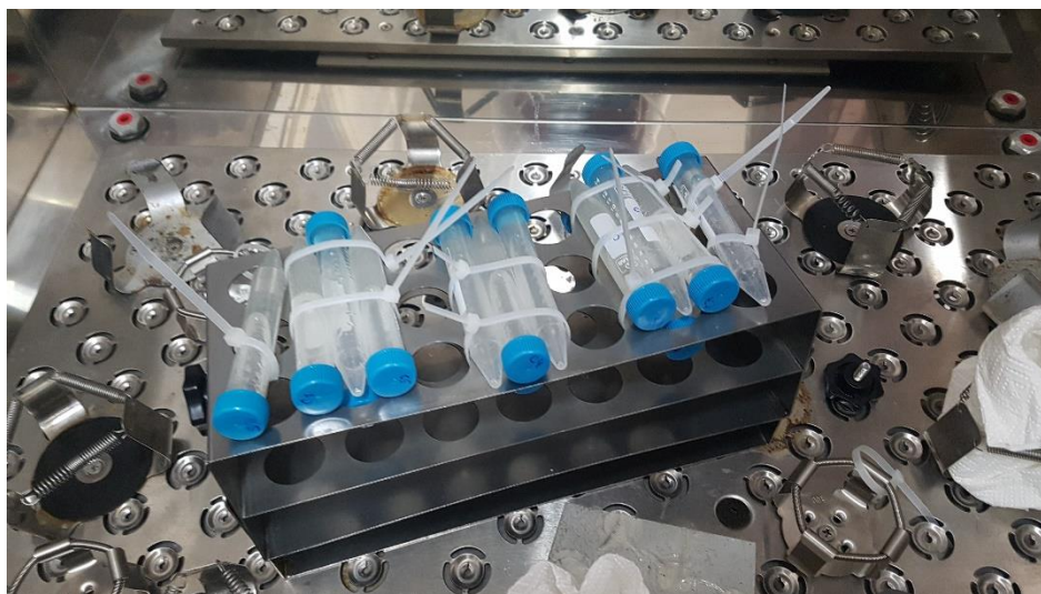
Slika 5. Falcon epruvete s reakcijskom smjesom pričvršćene na stalak u tresilici
