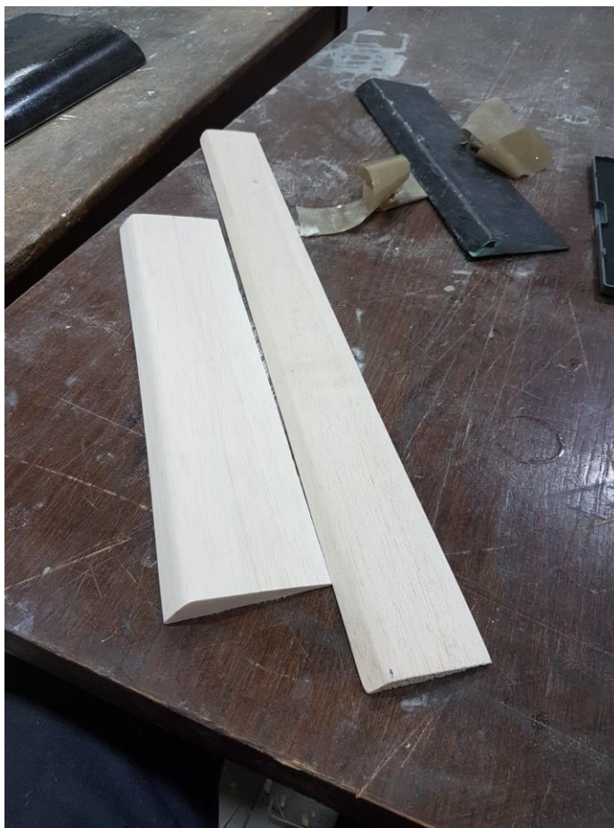
Slika 6.11 - Sirovac za izradu dijelova rebara od balze
