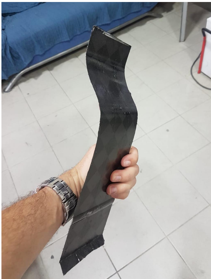
Slika 6.2 - Nosiva ploča nakon vakuumiranja i polimerizacije smole, prije konačne obrade
