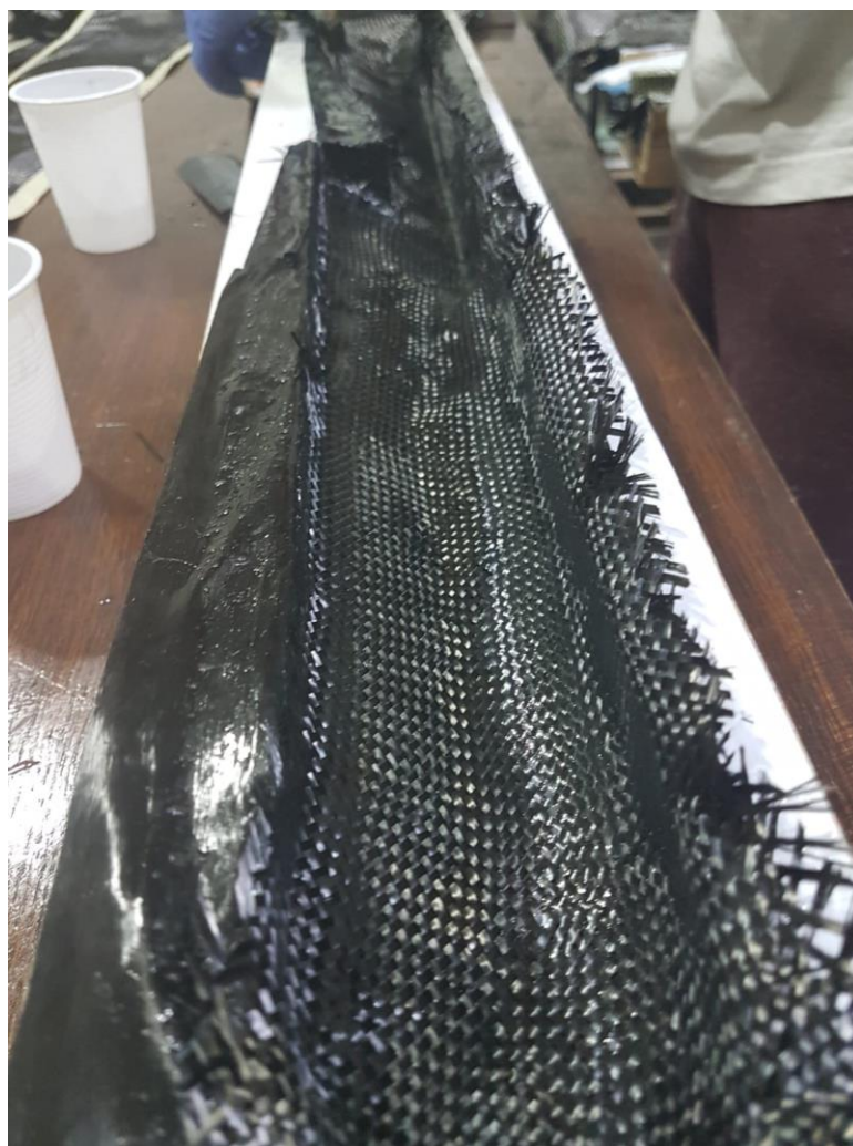
Slika 6.26 - Postupak izrade segmenta trupa
