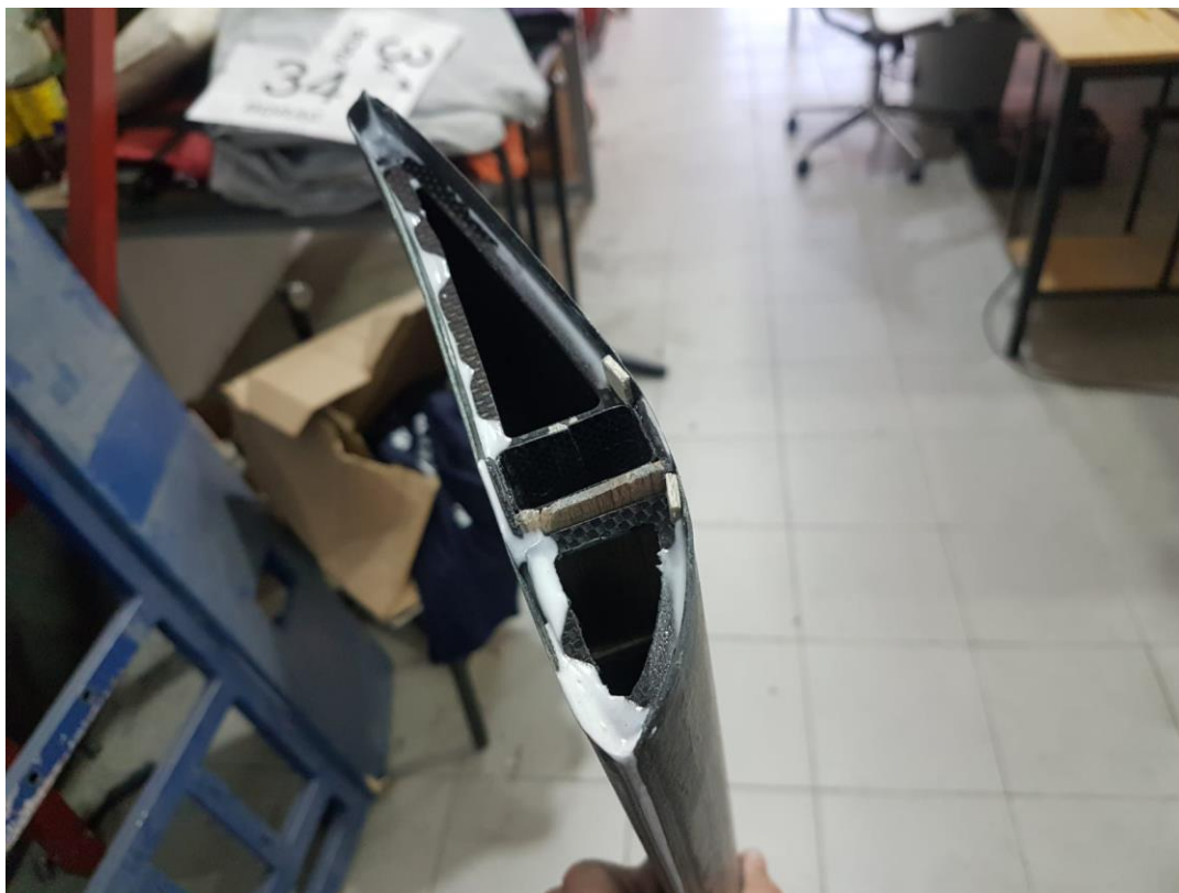
Slika 6.12 - Spoj rebra, ramenjače i oplata
