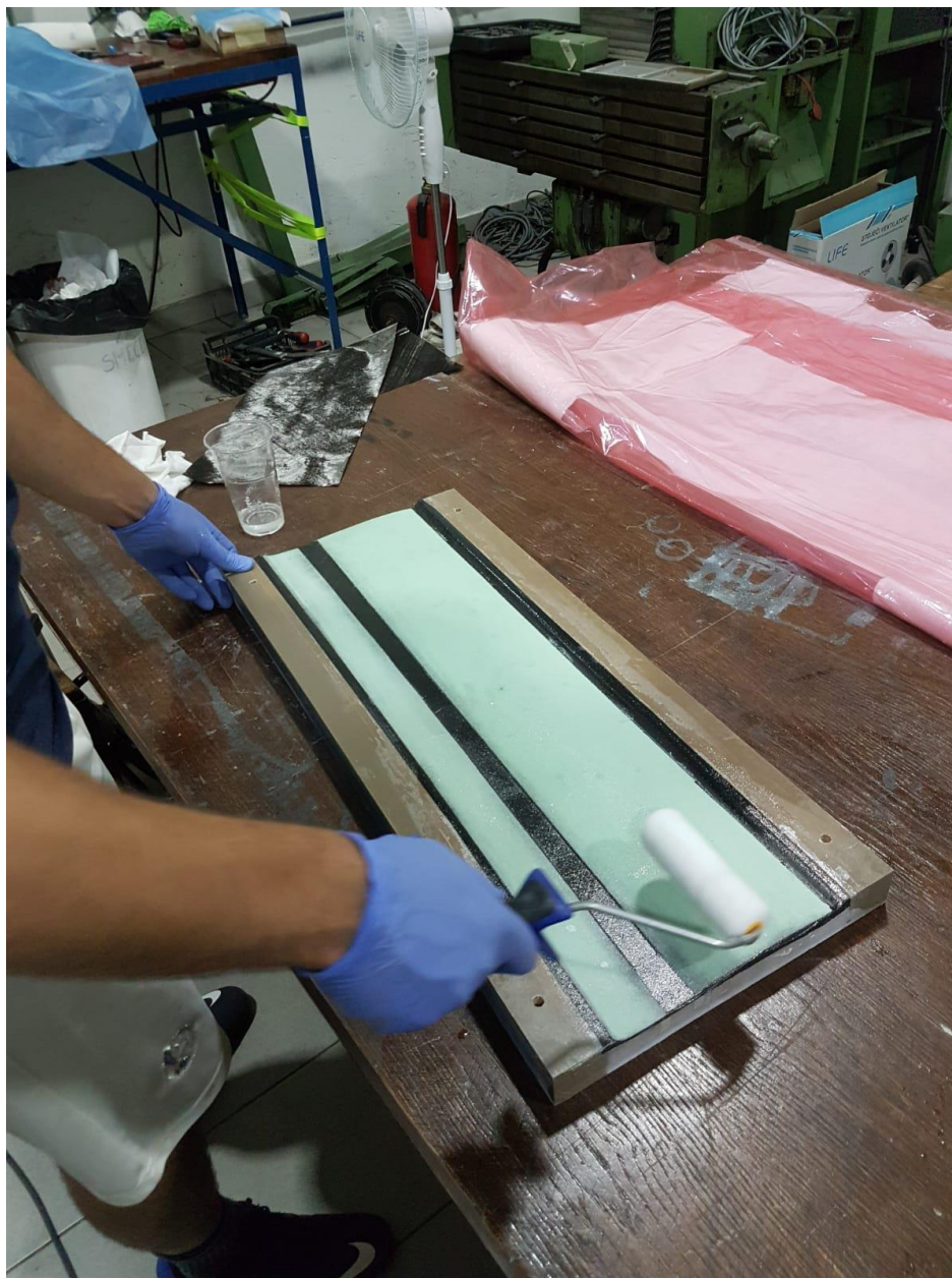
Slika 6.20 - Nanošenje epoksidne smole i airex pjene
