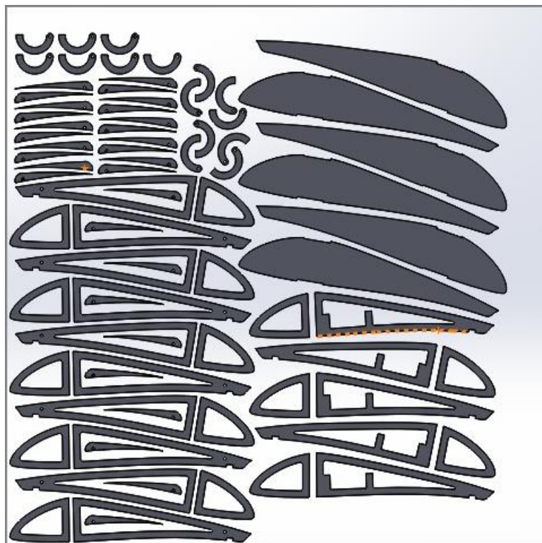
Slika 6.14 - Model dijelova rebara za CNC obradu
