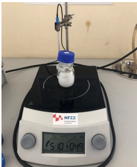
Slika 11. Sinteza kalcijeva fosfata iz kalcijeva karbonata (kalcit) i uree fosfata.
