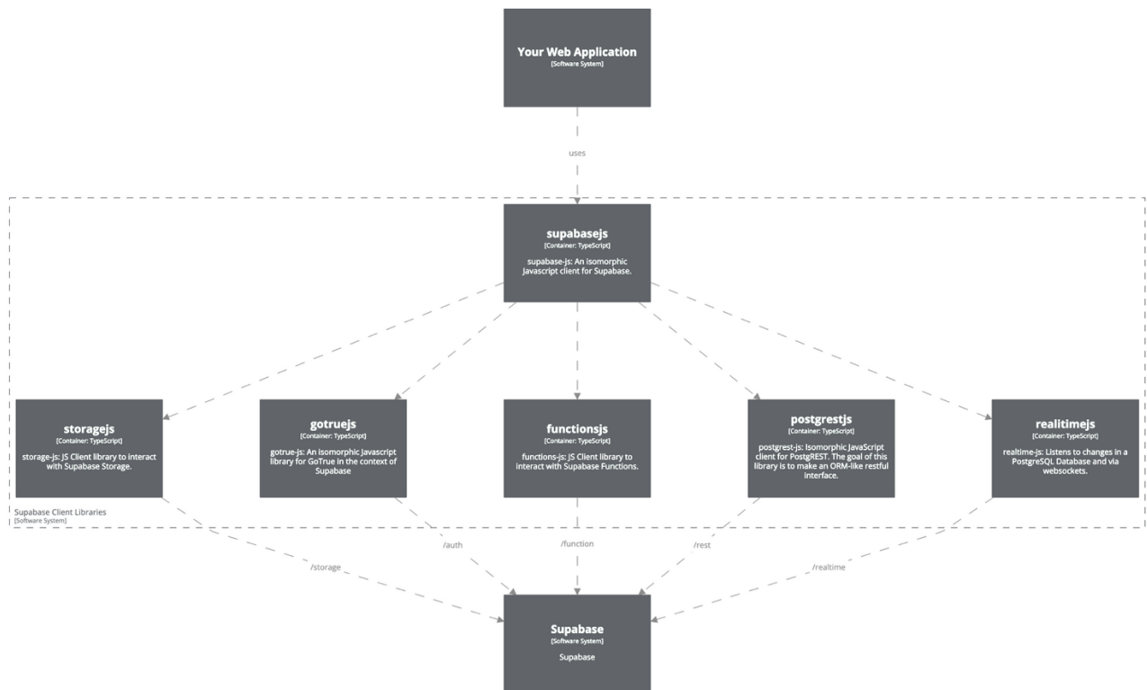
Slika 2.1. Arhitektura sustava temeljenog na Supabase platformi [7]
