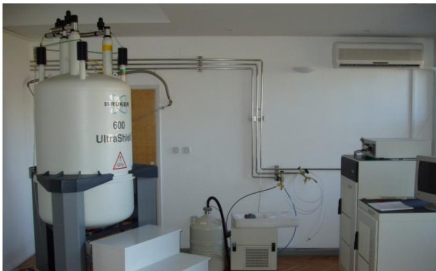
Slika 16. Fotografija NMR spektrometra Bruker Avance 600 (Bruker, Billerica, SAD)
