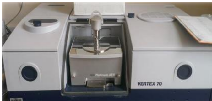
Slika 15. Fotografija FTIR spektrometra Vartex 70 s platinastim detektorom (Bruker, Billerica, SAD)
