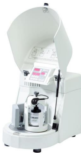
Slika 8. Fotografija planetarnog kugličnog mlina Pulverisette 6 (FRITSCH GmbH, Idar-Oberstein, SR Njemačka)
