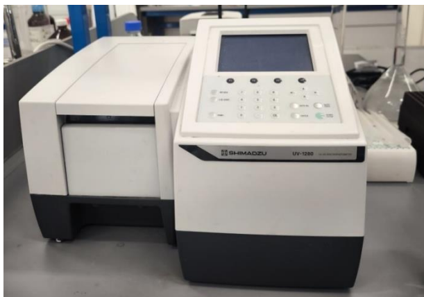
Slika 23. Fotografija spektrofotometra UV-1280 (Shimadzu, Kyoto, Japan)
