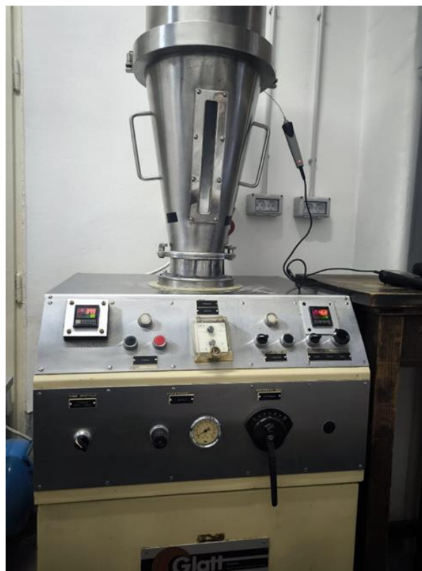
Slika 19. Fotografija granulatora s fluidiziranim slojem Uni-Glatt (Glatt GmbH, Binzen, SR Njemačka)
