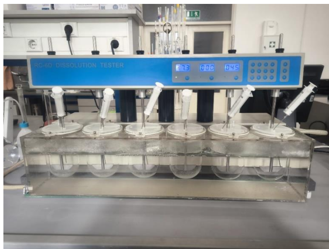
Slika 24. Fotografija uređaja za određivanje profila oslobađanja djelatne tvari RC-6D (Zhengzhou Nanbei Instruments, Zhengzhou, NR Kina)
