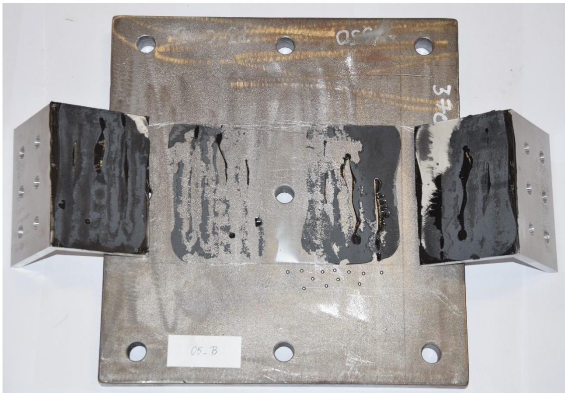
Slika 4.37 Prikaz lomnih površina ljepila uzorka 05_B
