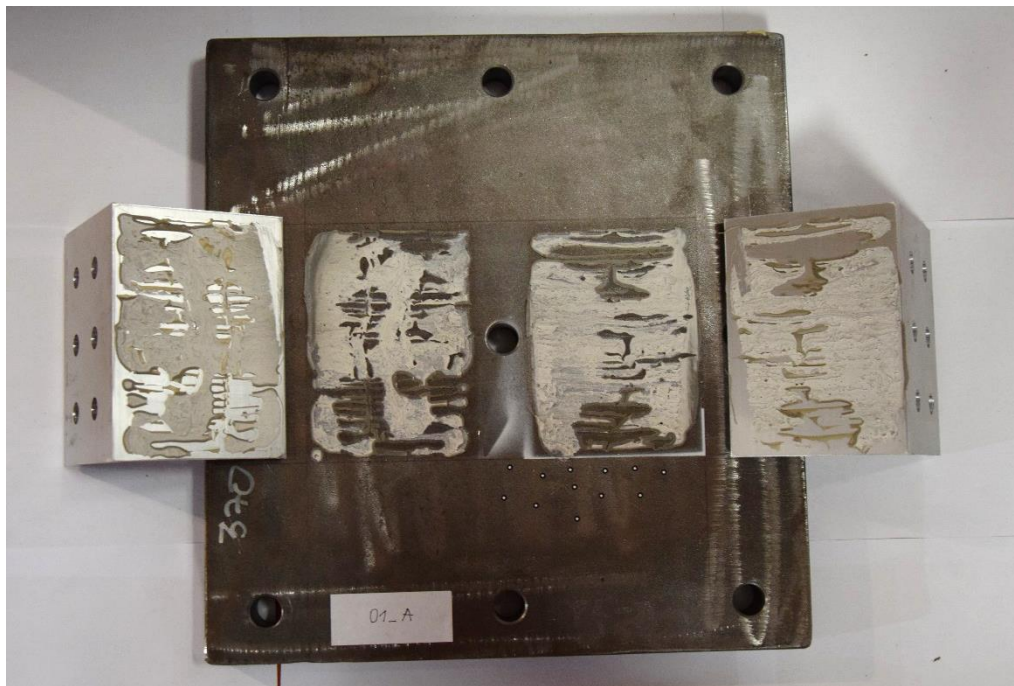
Slika 4.25 Prikaz lomnih površina ljepila uzorka 01_A
