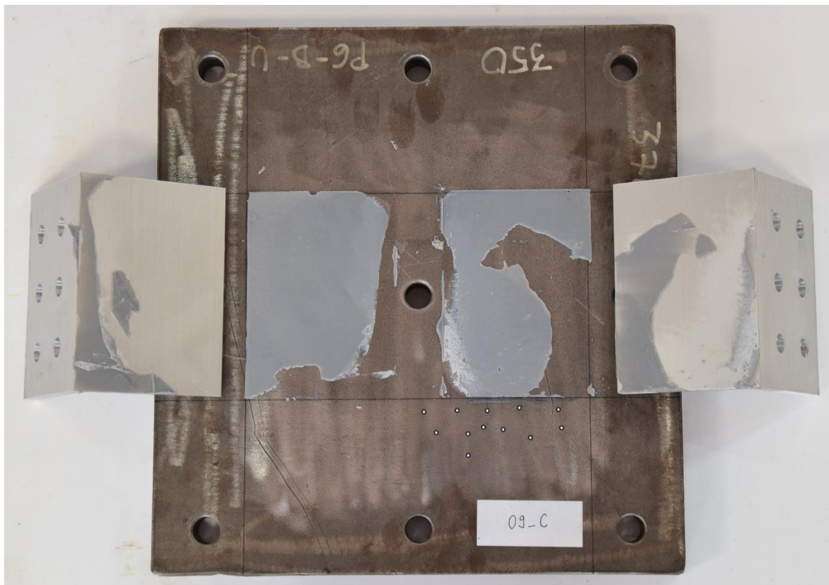
Slika 4.49 Prikaz lomnih površina ljepila uzorka 09_C
