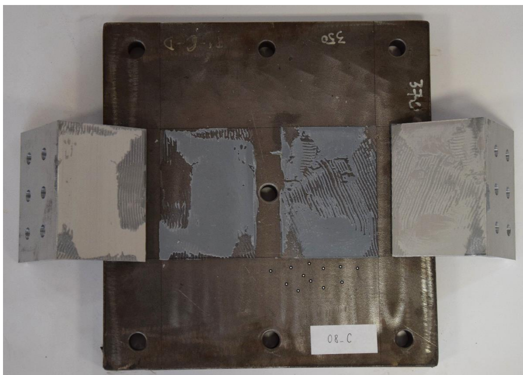
Slika 4.46 Prikaz lomnih površina ljepila uzorka 08_C
