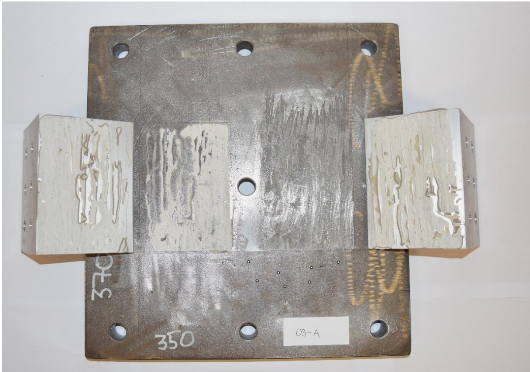
Slika 4.31 Prikaz lomnih površina ljepila uzorka 03_A
