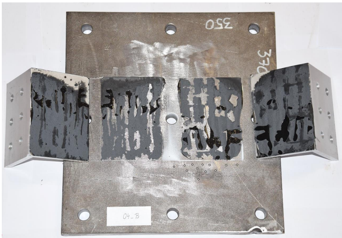
Slika 4.34 Prikaz lomnih površina ljepila uzorka 04_B
