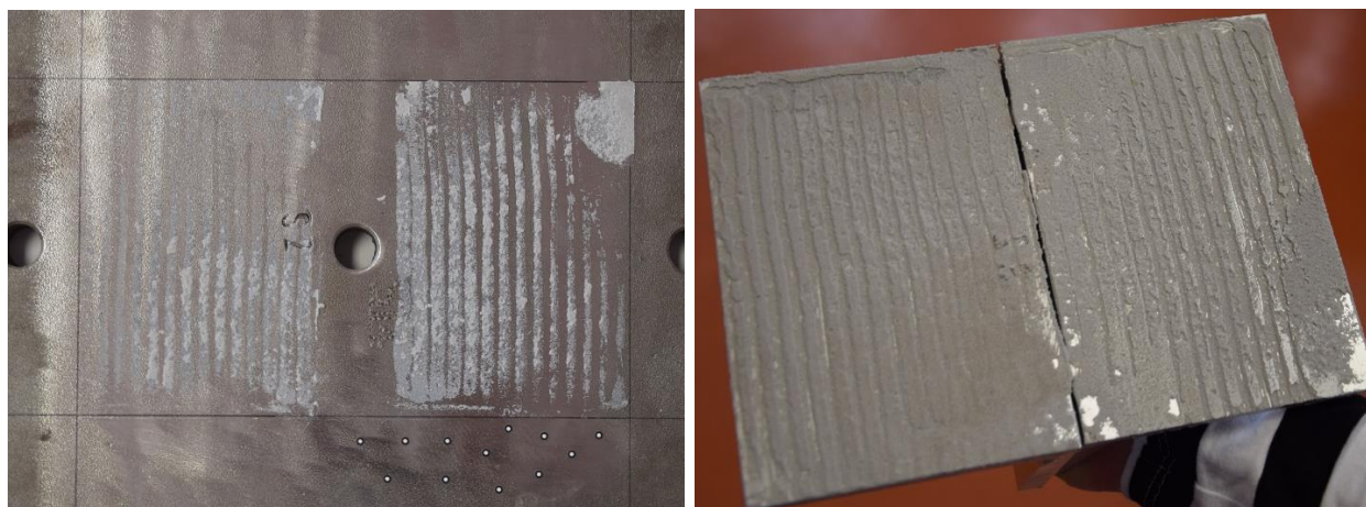
Slika 4.58 Prikaz lomnih površina ljepila uzorka 12_D
