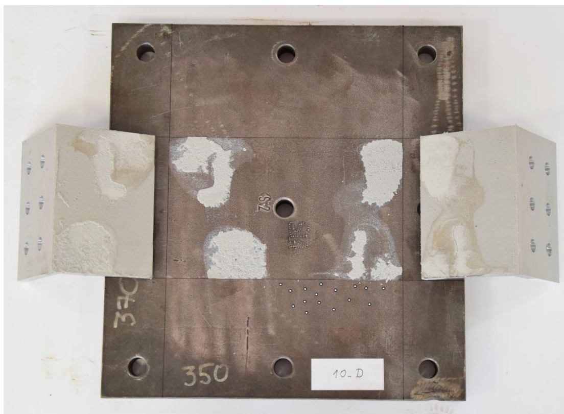
Slika 4.52 Prikaz lomnih površina ljepila uzorka 10_D
