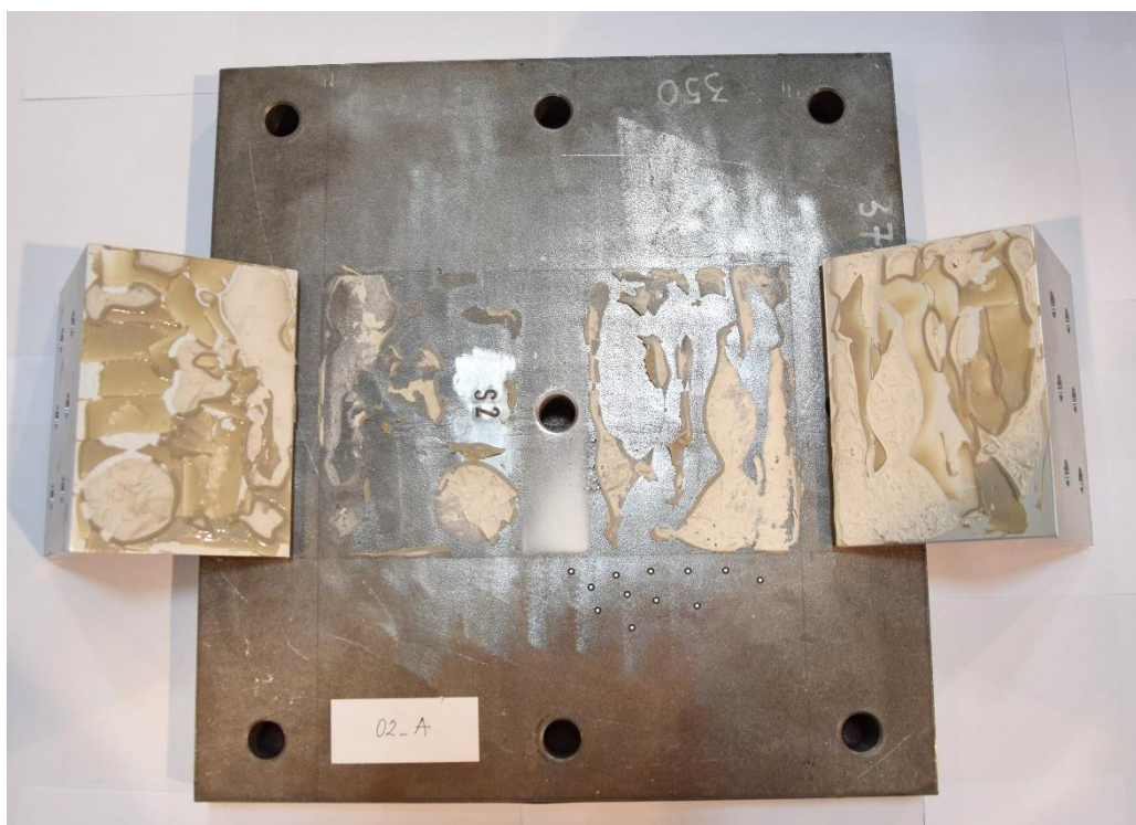
Slika 4.28 Prikaz lomnih površina ljepila uzorka 02_A
