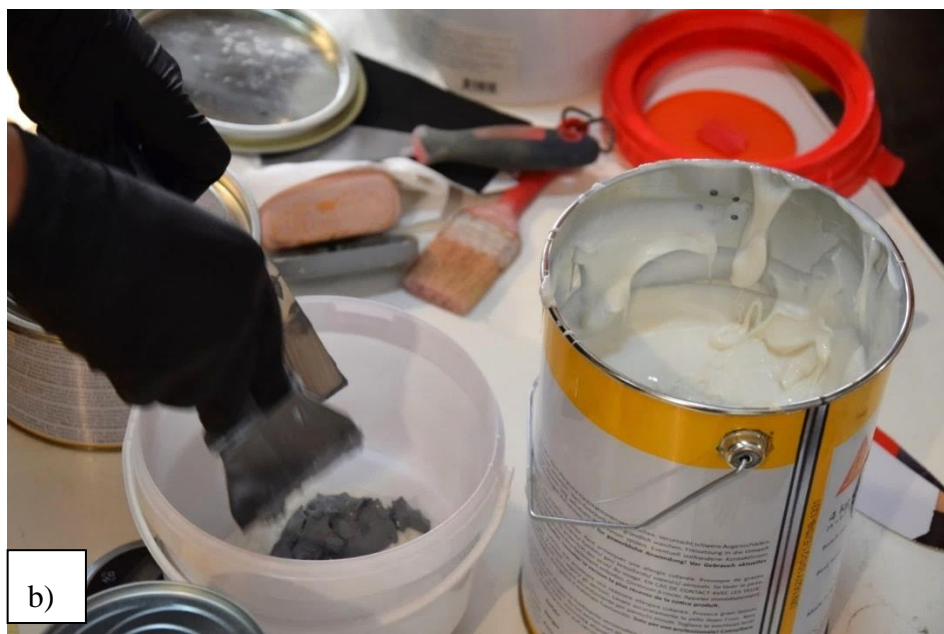
Slika 4.19 Miješanje A i B komponenti ljepila a) Sikadur 330 te b) Sikadur 31 CF-Normal
