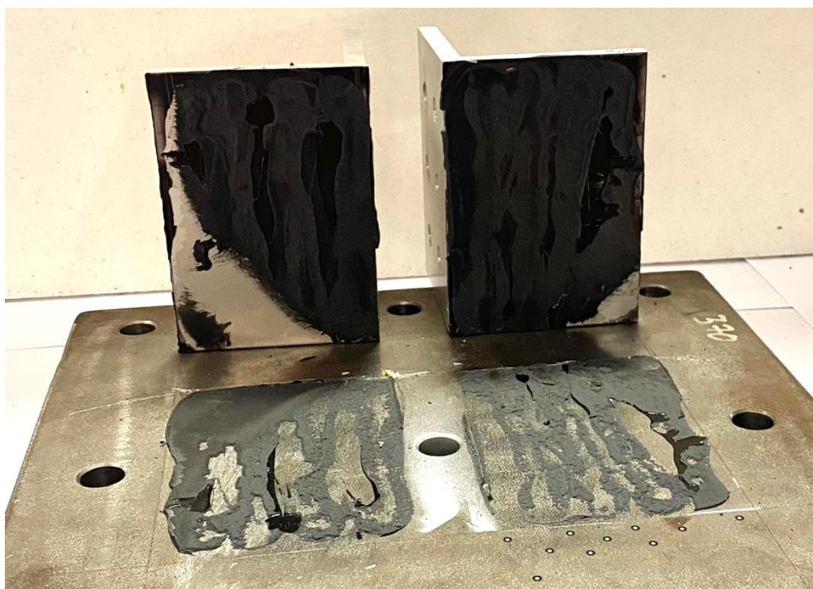
Slika 4.40 Prikaz lomnih površina ljepila uzorka 06_B
