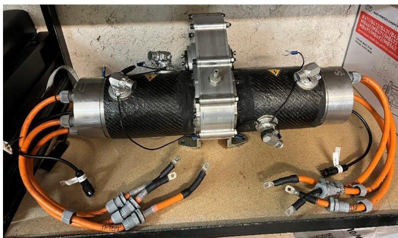
Slika 123. Pogonski motori spojeni na reduktor
