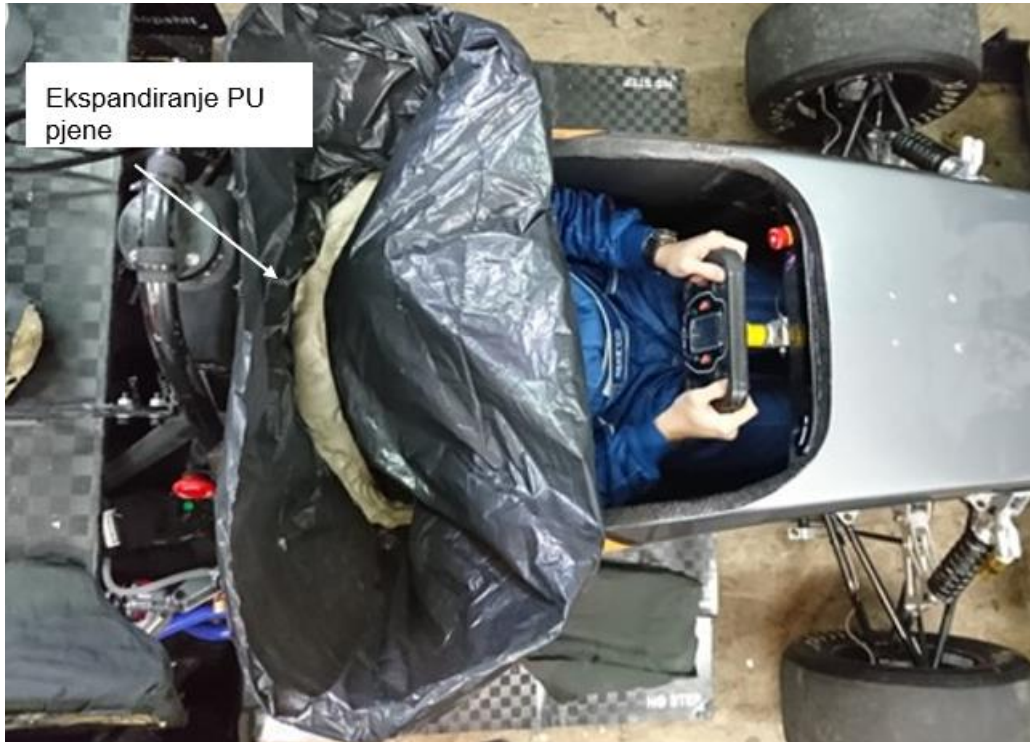
Slika 37. Izrada otiska od poliuretanske pjene
