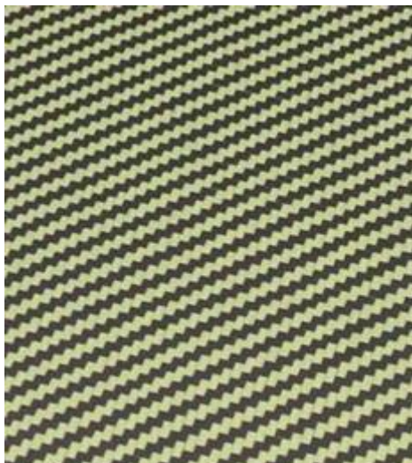
Slika 30. Polimer ojačan isprepletenim ugljičnim i aramidnim vlaknima
