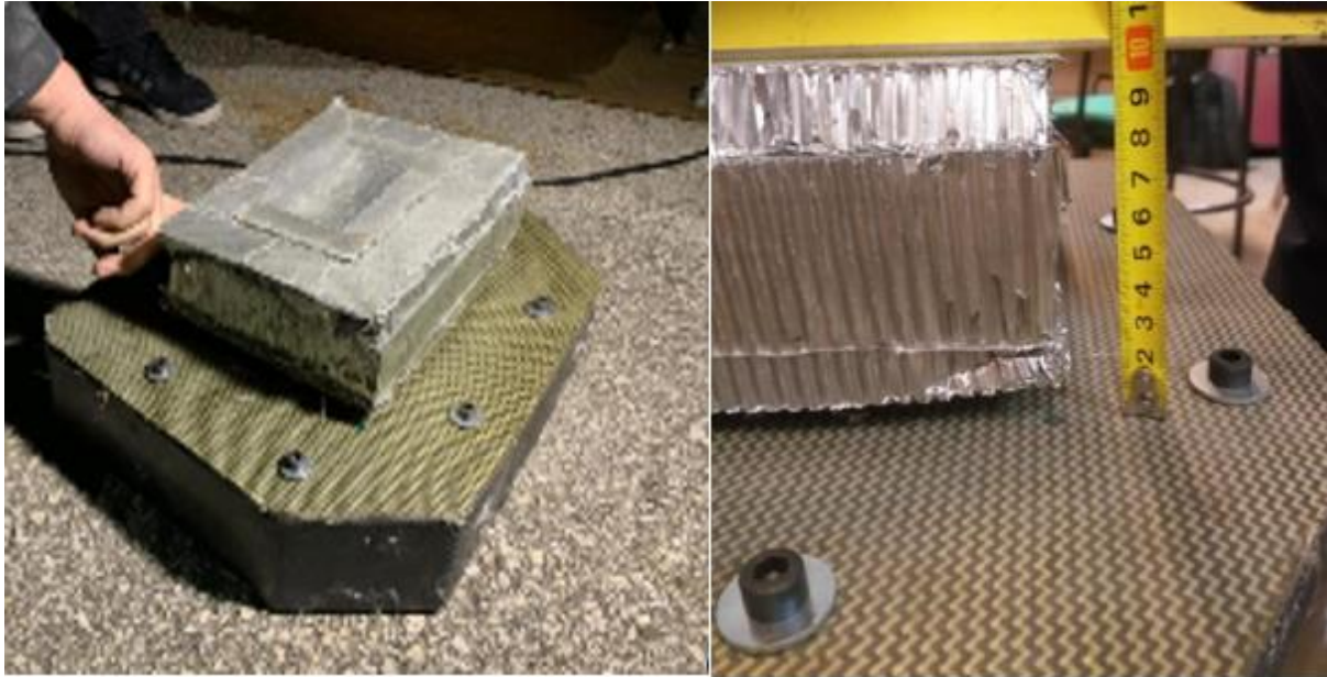
Slika 34. Ploča udarne zone nakon testiranja prikazana bez vidljivih oštećenja
