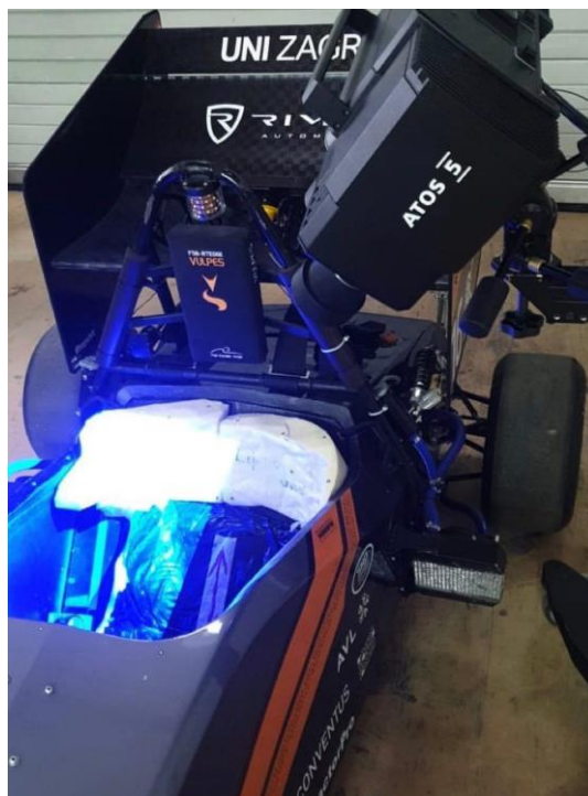
Slika 39. 3D skeniranje sjedala
