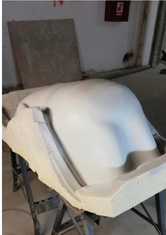
Slika 44. Površina kalupa nakon obrade
