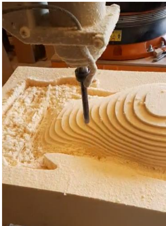
Slika 43. Glodanje kalupa sjedala
