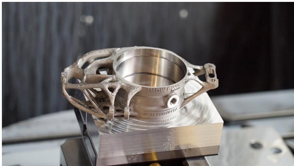
Slika 109. Nosač kotača VulpesR-a proizveden SLM tehnologijom
