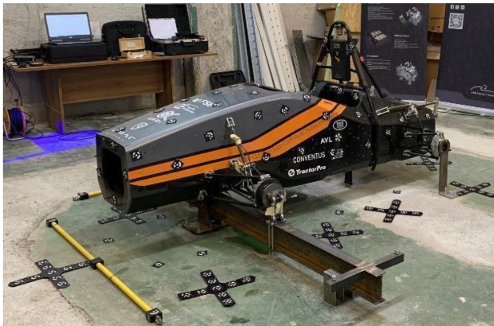
Slika 54. Ispitni postav za mjerenje torzijske krutosti šasije
