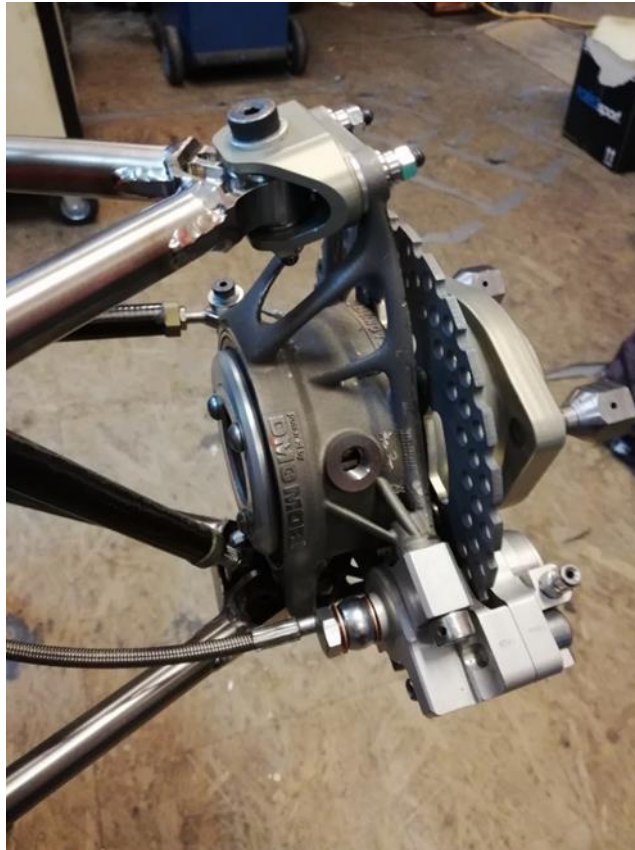
Slika 106. Prikaz sklopa kotača na VulpesR-u
