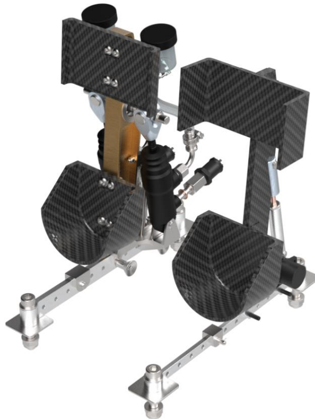
Slika 51. Sklop pedala bolida VulpesR – pedala kočnice (lijevo) i gasa (desno)
